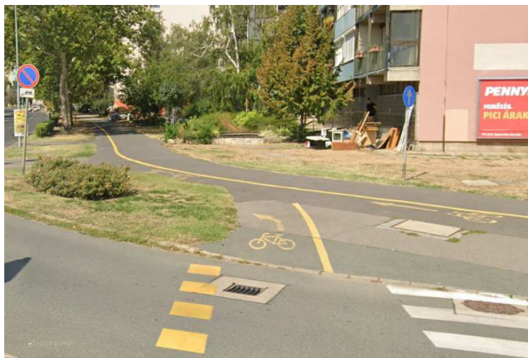
90. ábra: Kétoldali, egyirányú elválasztott gyalog- és kerékpárút szakasz
