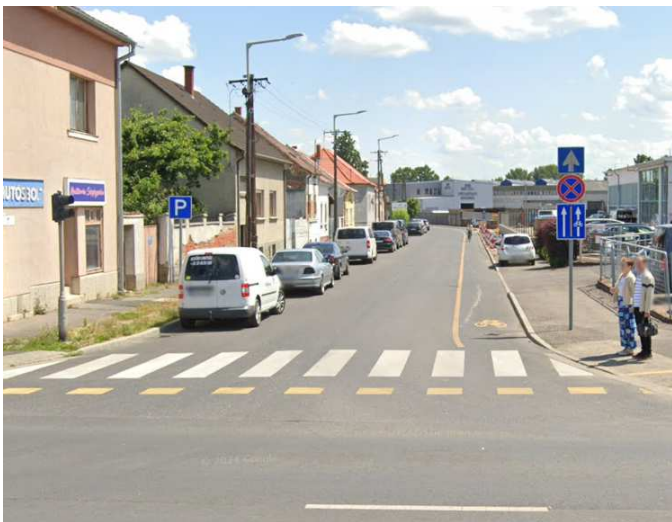
107. ábra: A Vépi úti egyirányú útszakasz irányhelyes kp.sávval
